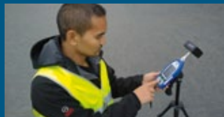
Calibration d'un sonomètre avant mesure
